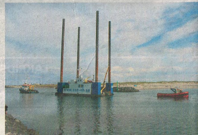
Havnen i Hvide Sande har en dybde på ca. 6 meter, så den vil ikke kunne tage de største boreplatforme, men der var ingen problemer med »Sound Prospector«, der kunne hæve benene tilstrækkeligt højt. Foto: Jesper Madsen
